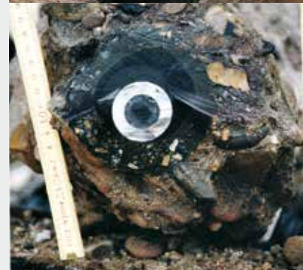
Abbildung versuchsweise ausgegrabener Verpresskörper im Querschnitt. Gut zu erkennen ist die Verzahnung von Stahltragglied, Zementstein-Überdeckung, Filterkuchen und Boden. Das eingeschlossene Stahltragglied mit Kopplungsmuffe ist dauerhaft korrosionsgeschützt.
